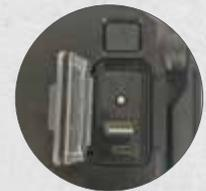
USB Ausgang 5 V / 1 A: Als Powerbank zum Aufladen von Mobiltelefonen etc. nutzbar.
