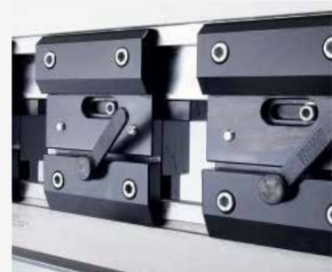
Oberwerkzeughalterung mit Schnellwechselsystem
