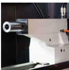
Hydraulisch betätigter Reitstock MK 4 serienmäßig
