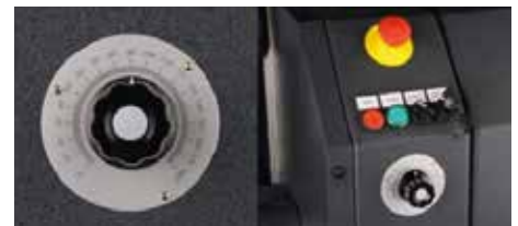
Inklusive manueller Winkeleinstellung mittels Potenziometer
