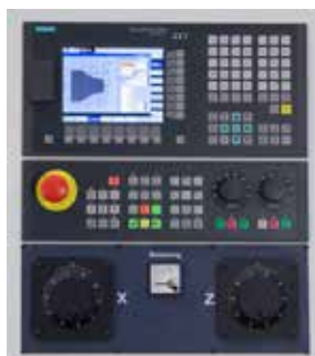
Zentrales Bedienpanel mit zwei elektronischen Handrädern
