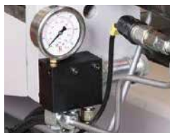
Spanndruckregelung des Spannstockes
