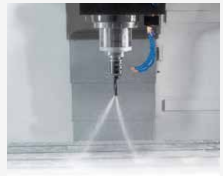
Innenkühlung, Kühlmittel durch Spindel
