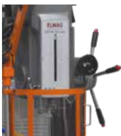
Am Bedienhebel schaltbare Drehrichtungsumkehr bei GBFM 50 GAL
