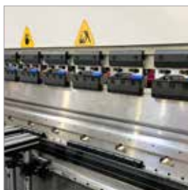
Oberwerkzeughalterung mit Schnellwechselsystem
