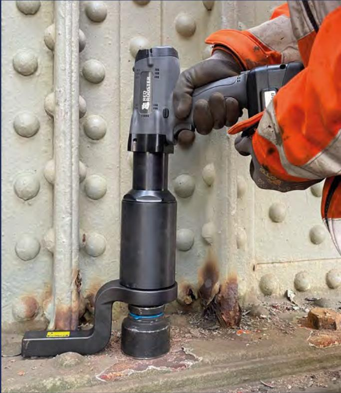
Red Rooster hat eine Reihe von Akku - Hochmomentschraubern mit bis zu 2500Nm entwickelt. Benutzerfreundlichkeit, Geschwindigkeit und Genauigkeit sind die wichtigsten Merkmale. Die RRI-BEC-Serie verfügt über die höchste Drehzahl in diesem Produktsegment. Das Drehmoment kann einfach über das rückseitige Display eingestellt werden.
