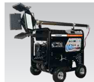
› Lichtmast für den Transport demontierbar
