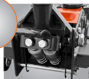
› Quick-Lift Funktion durch Doppelkolben
