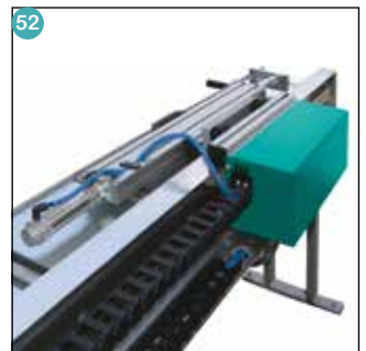
Längenanschlag LM 110 DH Arm und Federdämpfung (Option)
