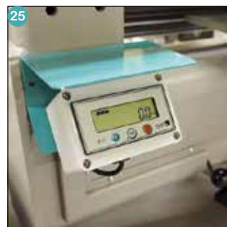
Digitale Anzeige der Gehrungseinstellung
