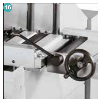
Heberolle Manuell angetrieben
