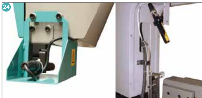
Laser zum Sägen auf Anriss
