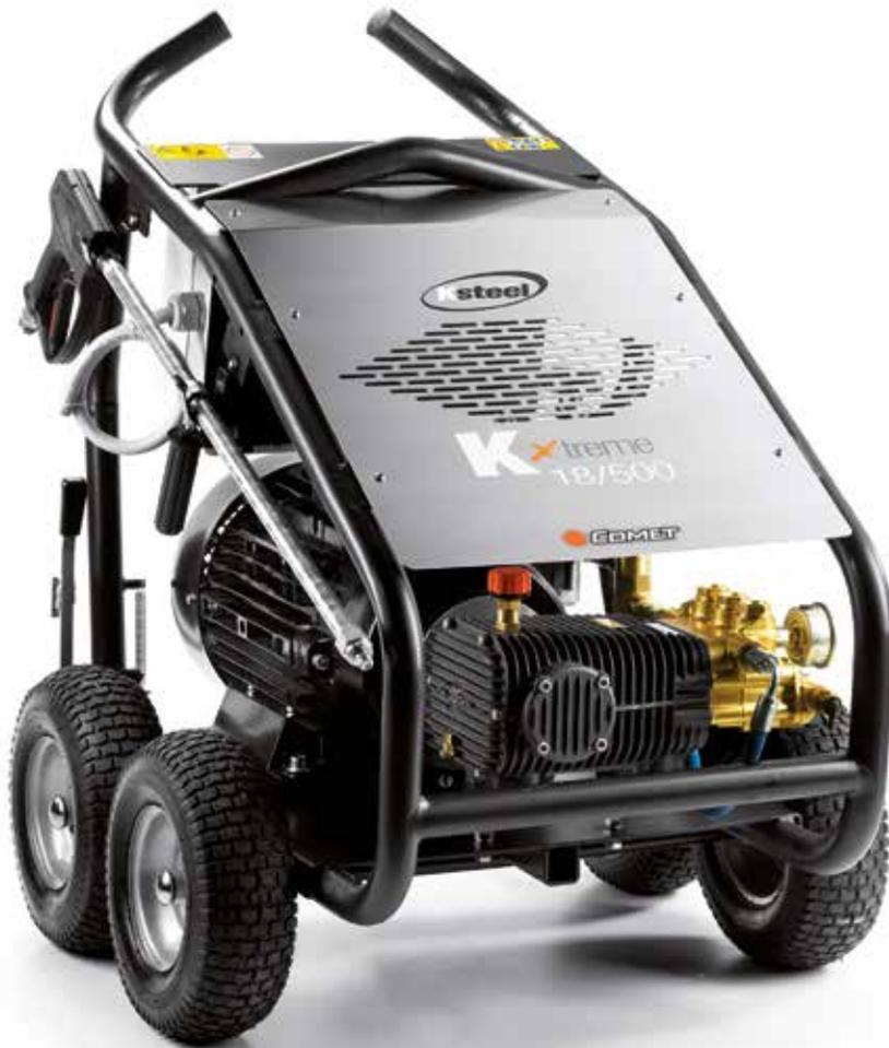
Die elektrischen COMET Kaltwasserhochdruckreiniger K Xtreme sind für härteste und anspruchsvollste Arbeiten konzipiert. Ihre robuste Bauweise und die großen Räder garantieren lange Einsatzzeiten und hohe Mobilität am Einsatzort. Strahlrohr und Pistole können benutzerfreundlich am Gerät verstaut werden.
