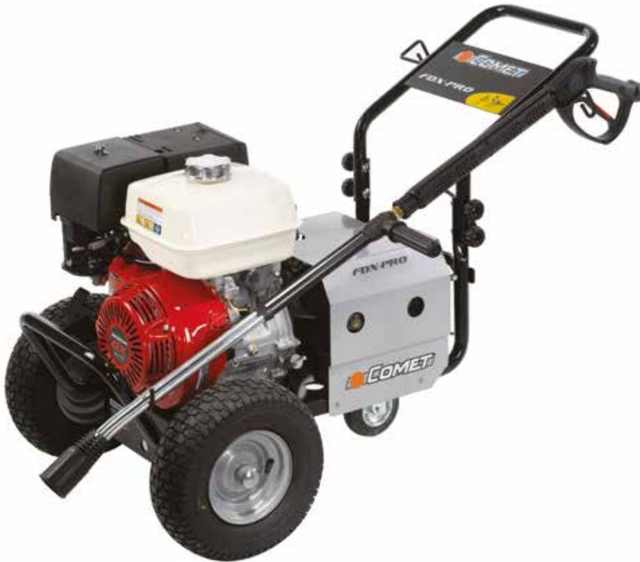
Flexibel am Einsatzort, kraftvoll bei der Arbeit. Der COMET FDX PRO 15/300 ist mit einem 13 PS Honda GX 390 Benzinmotor und Ölstandsanzeige ausgestattet. Vier Räder (zwei große mit Luftbereifung und zwei flexible Rollen) garantieren eine leichte Handhabung des Hochdruckreinigers.
