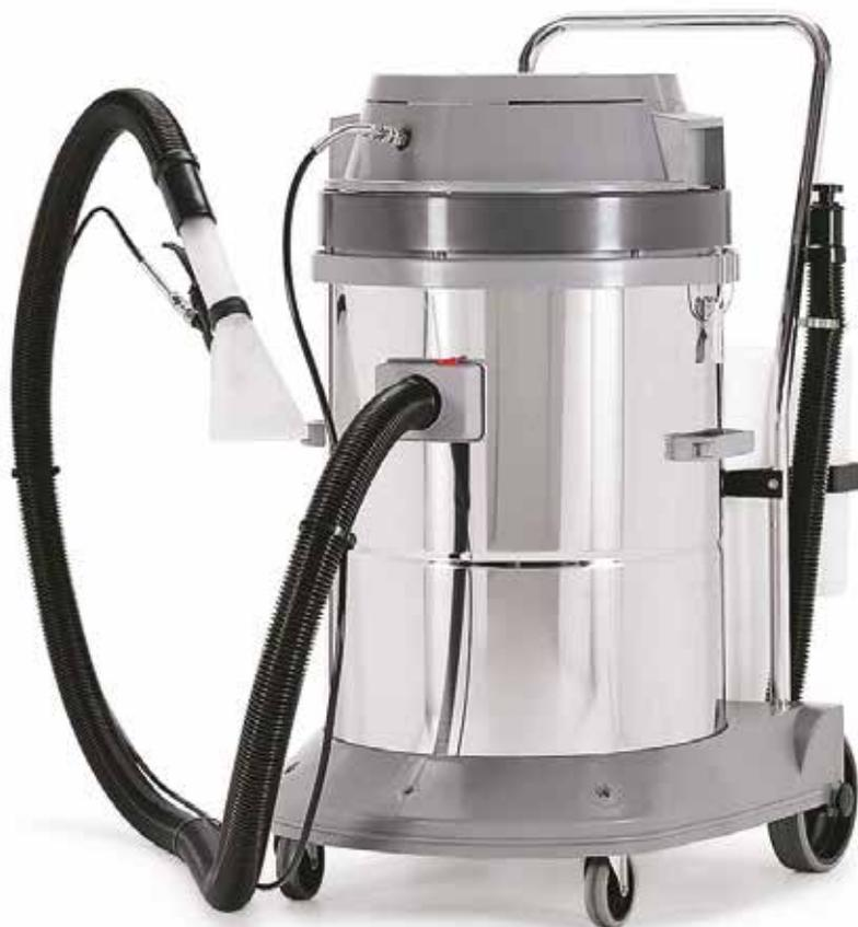
EXTRACT A58.3 ist das besonders leistungsstarke Sprühextraktionsgerät für die Reinigung aller textilen Oberflächen, wie Polstermöbel, Fahrgastsitze, Teppichböden etc. Der EXTRACT A58.3 ist, mit seinem 2x 1.100 Watt Motor, kraftvoll und vielseitig in den Einsatzmöglichkeiten. Die sehr großen Reinigungsmittel- und Schmutzwassertanks garantieren schnelles und kontinuierliches Arbeiten ohne störende Unterbrechungen.
