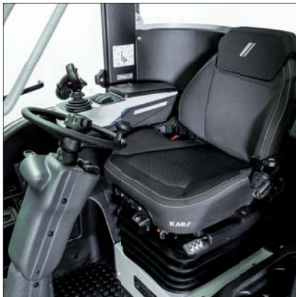
Entkoppelte Fahrerkabine mit luftgefedertem Komfortsitz, Sitzheizung und Längsdämpfung
