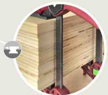
Schiene aus gehärtetem Rechtestahl.
