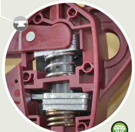
Stahlblechsatz für Bremse und Vorschub.
