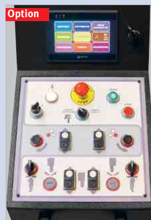
Option: NC-Steuerung mit Touchscreen und Teach-In-Funktion
