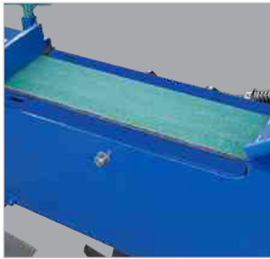
Große Planschleiffläche mit Werkstückanschlag
