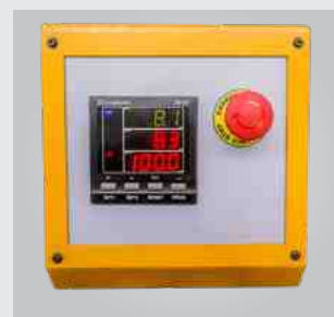
Bedienpult mit Digitalanzeige und NOT-AUS-Schalter
