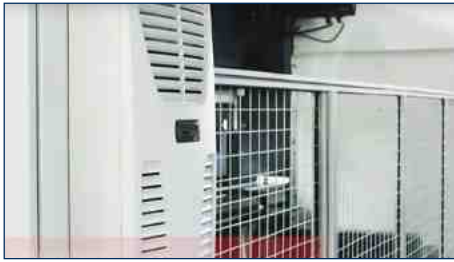
Sicherheitslaser Fiessler AKAS LC 5 Sicherheitslaser für den Hand- und Fingerschutz ermöglicht den Eilgang der Oberwange bis nur 2mm über das Werkstück
