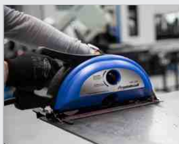
Zweifach geführtem Parallelanschlag für exakte Schnittführung
