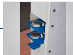
Mit praktischen Ablagen für alle Einzelsegmente und Biegeschienen
