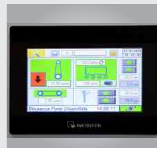
Bedienung der Maschinenfunktionen über 8" Touchscreen
