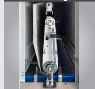
Eine Schleifbandeinheit zu Entgraten und zum Blankschleifen
