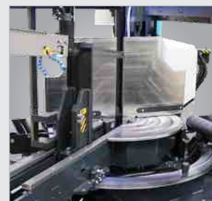
Drehteller mit seitlichen Materialauflagerollen
