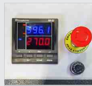
Einfache Bedienung, mit digitaler Anzeige für aktuelle Biegewerte und zum Setzen der Parameter
