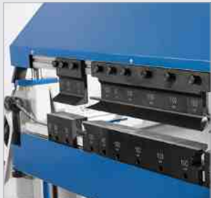
Alle drei Werkzeuge segmentiert und mit Schnellwechselsystem
