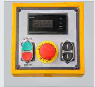
Digitale Positionsanzeige für Zustellwalze
