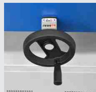
Manuelle Höhenverstellung des Arbeitstisches mit numerischer Anzeige
