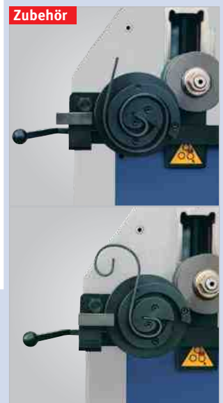
Anwendung Spiralbiegen mit optionalem Biegewerkzeug
