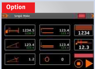
Optionale Steuerung Schneider NC2: Optionaler motorischer Hinteranschlag 10 - 1000mm mit Steuerung NC2. Der Hinteranschlag ist ausgeführt als massiver Auflagetisch mit Anschlagfingern die über Kugelumlaufspindeln angetrieben werden. Die Steuerung Schneider Magelis ist hier erweitert und ermöglicht die einfache Positionierung des Hinteranschlages und der Klemmwange. Der Programmspeicher bleibt gleich
