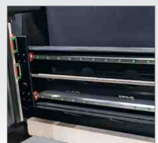
Die über Kugelumlaufspindeln angetriebene X-Achse läuft auf doppelter Linearführung
