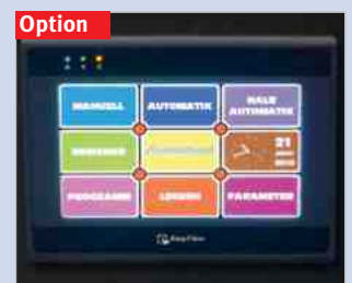
NC-Steuerung mit Touchscreen und Teach-In-Funktion
