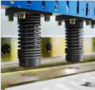
Massive hydraulische Nieder- halter zur sicheren Fixierung des Blechs während des Schneidvorgangs
