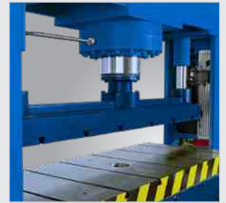
Großer Auflagetisch mit T-Nuten und mittlerer Bohrung
