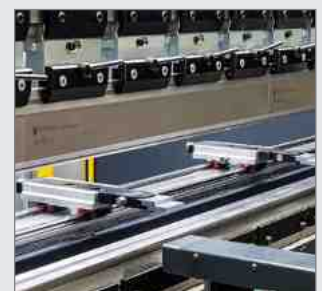
Hinteranschlag X/R mit manuellen Z-Achsen
