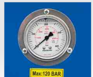
Manometer zeigt Zustelldruck
