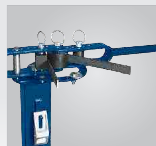
Biegen von Rundungen in Flachmaterial
