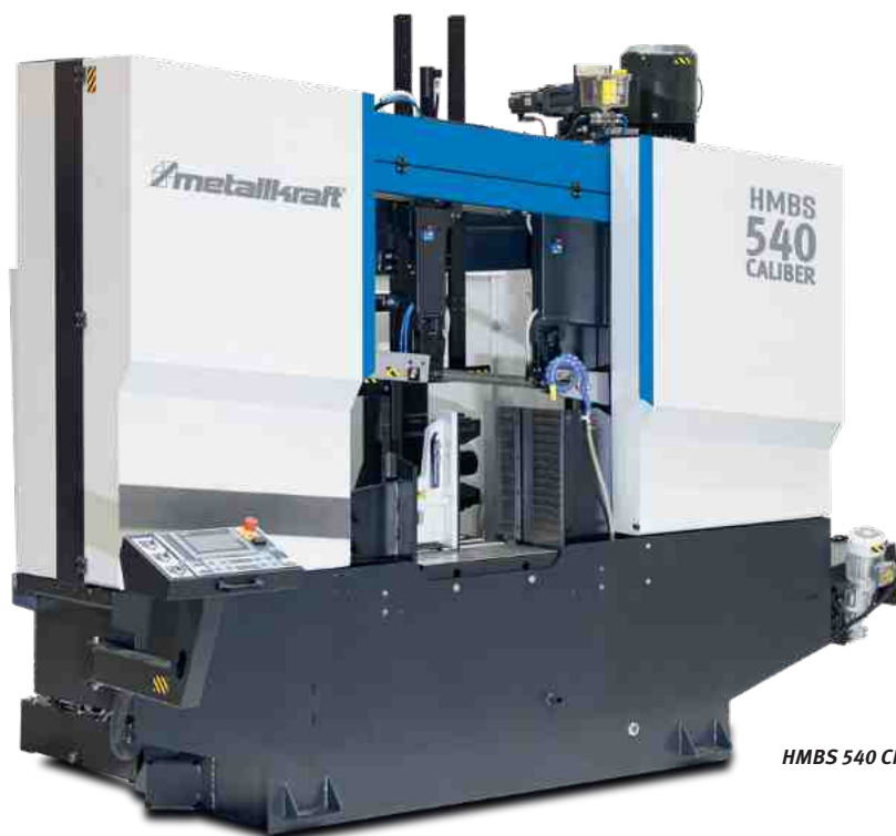
Sägebandneigung von 7° und hydraulische Sägebandspannung erhöhen die Standzeit des Sägeblattes
