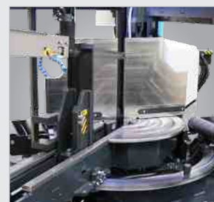
Drehteller mit seitlichen Materialauflagerollen
