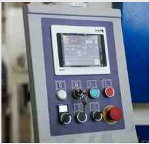
Touchscreen NC-Steuerung Elgo P40T
