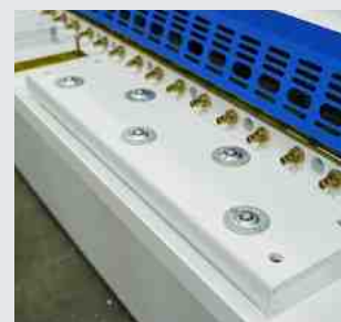
Tischauflagen besetzt mit Transferkugeln für leichtere Handhabung von schweren und großen Teilen
