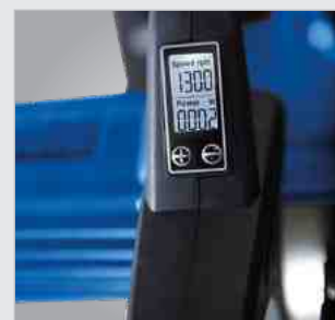
Digitales Display. Unter anderem zur Anzeige der Sägeblattdrehzahl
