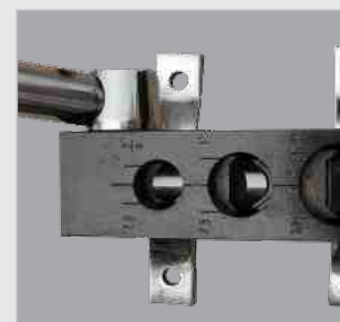
Bis zu drei verschiedene Rohrdurchmesser auslinkbar (MRA2)
