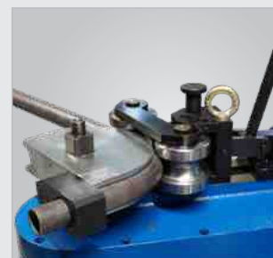
Effizientes Biegen von Metallprofilen zu präzisen Ringen und Bögen
