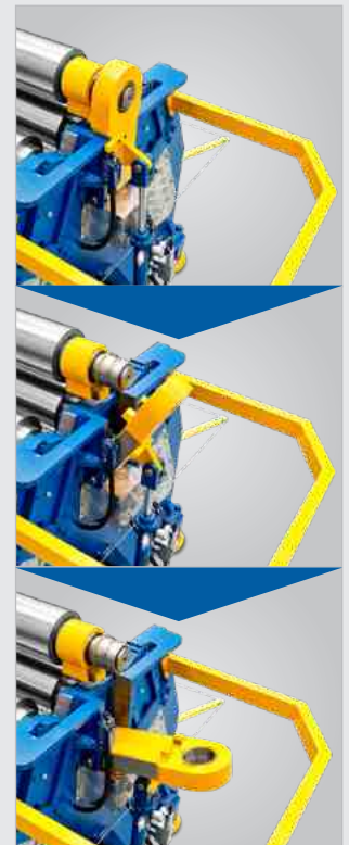
Hydraulisches Klapplager zur leichten Entnahme des Materials
