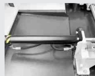
Langhubzylinder an beiden Spannstöcken
