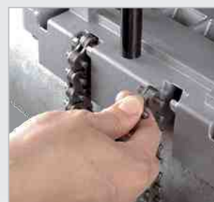
Halterung für Rohre mit einfachem Schnellspannsystem und Kette
