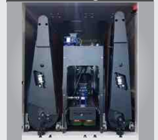
MBBS 1350-17 RXR Zwei Schleifbandeinheiten und eine Schleifbürsteneinheit
