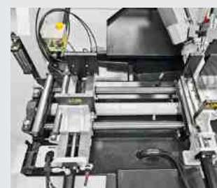
Materialvorschub über Kugelumlaufspindel
