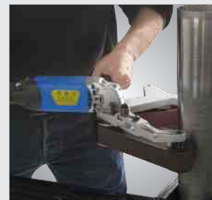
Optimal zum Schleifen und Polieren von Rohrkonstruktionen
