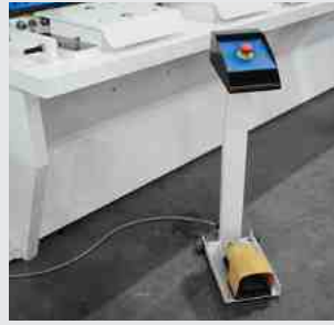
Komfortable Fußpedalbedie- nung für den Schneidvorgang
