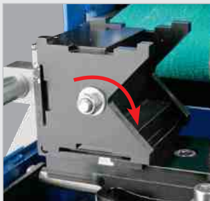
Große, klappbare Schutzscheibe mit optimalem Sichtfeld
