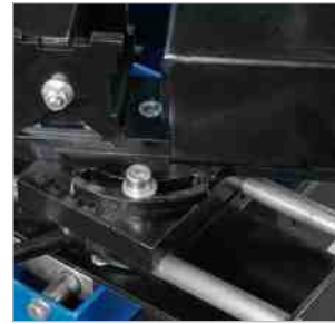
Schleifwinkel von 30-90° anhand einer Skala einstellbar
