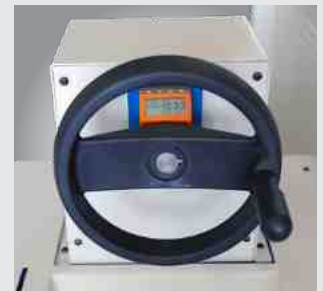
MTBS 2103 F / MTBS 3102 F Bedienung des Hinteranschlags von der Maschinenfront über Handrad mit Zählwerk
