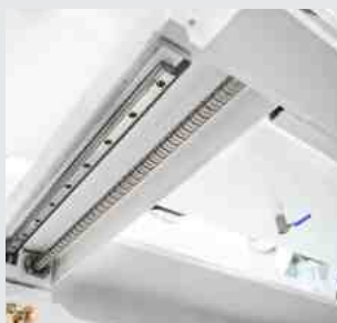
Motorisch gesteuerter Hlnter- anschlag mit Kugelumlauf- spindeln und massiven Linear- führungen
