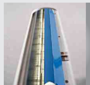
LED-Schnittlinienbeleuchtung und Sichtschlitze
