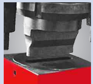
Optionale Stanzeinrichtung für große Durchmesser
