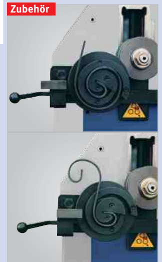
Anwendung Spiralbiegen mit optionalem Biegewerkzeug
