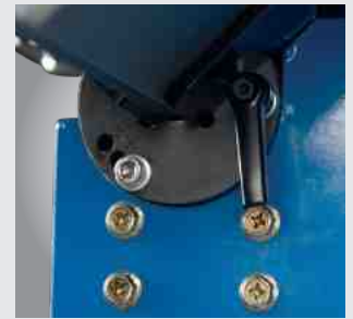
3 verschiedene Standard-Winkel-einstellungen von 15°, 30° und 45°
