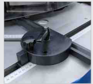
Exakte Winkeleinstellung mithilfe von Anschlägen und Skalen
