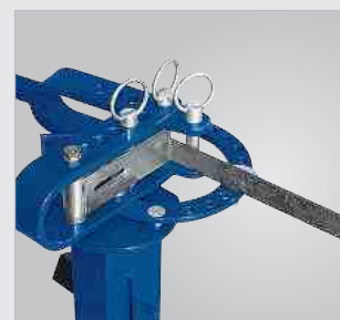
Anwendung Flachmaterial: Scharfbiegen
