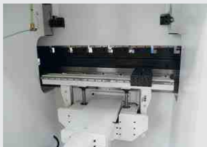
CNC-gesteuerter Hinteranschlag mit zwei Hinteranschlagfingern
