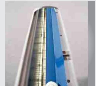
LED-Schnittlinienbeleuchtung und Sichtschlitze
