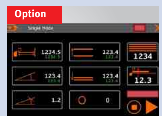
Optionale Steuerung Schneider NC2: Optionaler motorischer Hinteranschlag 10 – 1000mm mit Steuerung NC 2. Der Hinteranschlag ist ausgeführt als massiver Auflagetisch mit Anschlagfingern die über Kugelumlaufspindeln angetrieben werden. Die Steuerung Schneider Magelis ist hier erweitert und ermöglicht die einfache Positionierung des Hinteranschlages und der Klemmwange. Der Programmspeicher bleibt gleich
