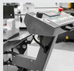
Schwenkbares Bedienpult Ihr Nutzen: Erleichtert das Arbeiten auch bei Schnitten auf Anriss
