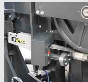
Elektrisch angetriebene Späneräumbürste
