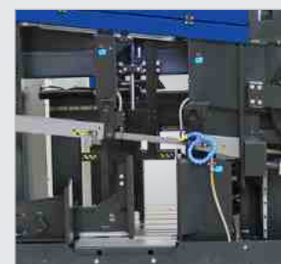
Sägebandneigung von 7° und hydraulische Sägebandspannung erhöhen die Standzeit des Sägeblattes
