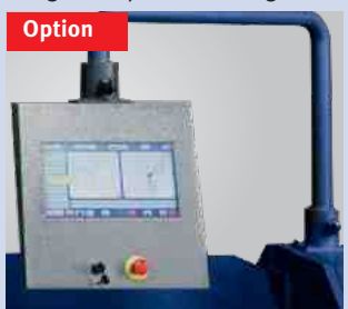
Optionale CNC-Steuerung mit 3D-Grafik, die Profile werden vom Bediener auf einem großzügigem 19" Touchscreen gezeichnet, sämtliche Achspositionen und die Biegefolge werden von der Steuerung errechnet, motorischer Hinteranschlag mit Anschlagfingern, Verfahrbereich 10-1000 mm
