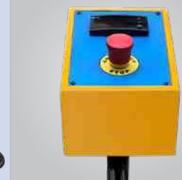
Steuerpult mit Digitalanzeige der Seitenwalze
