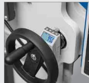
Verstellung des Hinteranschlages über Handrad mit Zählwerk
