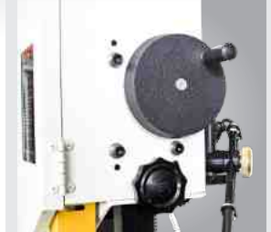
Höhenverstellung der Sägebandführung per Handrad
