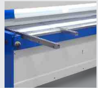
Arbeitstisch mit massiven Auflagearmen
