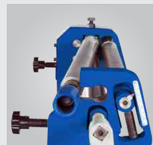
Die obere Walze ist ausstellbar, dadurch einfache Entnahme des fertigen Werkstücks
