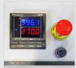
Einfache Bedienung, mit digitaler Anzeige für aktuelle Biegewerte und zum Setzen der Parameter
