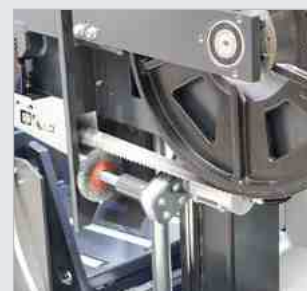
Elektrisch angetriebene Späneräumbürste
