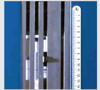
Obere, untere Endlage des Kolbenhubs sowie Umschalt-punkt von Eil- auf Pressgang stufenlos über Nockenleiste einstellbar
