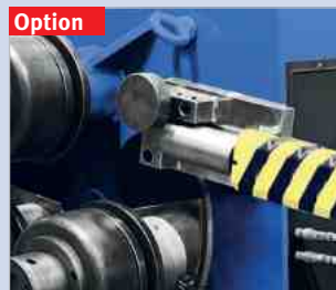
Option: zwei hydraulische seitliche Führungsrollen
