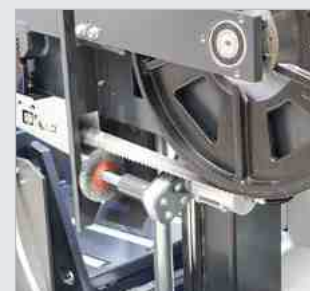
Elektrisch angetriebene Späneräumbürste
