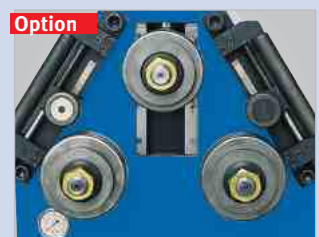
Option Spezial-Richtrollen seitlich, für Winkelstahl
