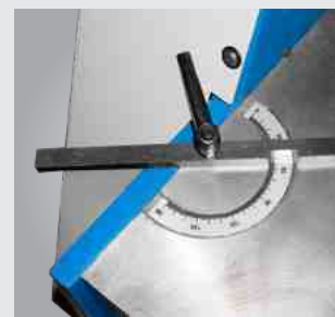
Winkelverstellbarer Seitenanschlag mit Gradskala
