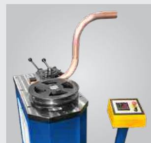
Biegewinkel bis 180° möglich
