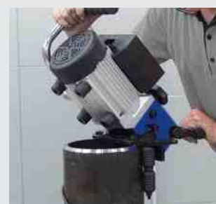
Entgraten von Rohren möglich
