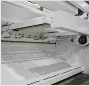
Motorisch gesteuerter Hinteranschlag mit Kugelumlaufspindeln
