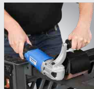
Satinieren von flachem Material
