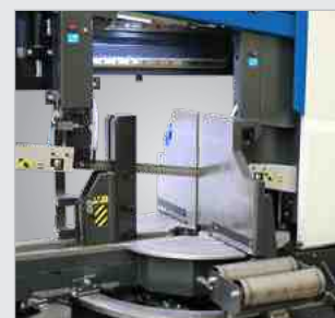
Drehteller mit seitlichen Materialauflagerollen
