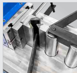
Mit Schnellwechselaufnahme und Seitenanschlag mit Skala
