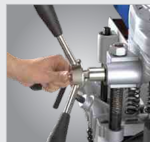
Die Vorschubkurbel kann je nach Bedarf auf der linken oder der rechten Seite der Maschine angebracht werden
