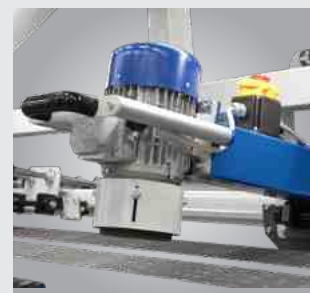
Tellerschleifaggregat für punktuelle Bearbeitung z.B. Polieren von Schweißnähten
