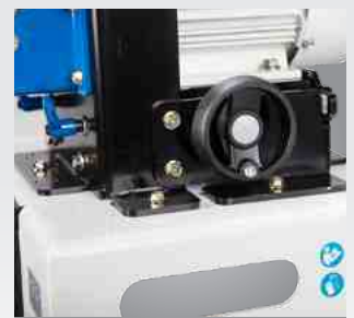
Stufenlose Einstellung der Fasentiefe ohne Werkzeug möglich
