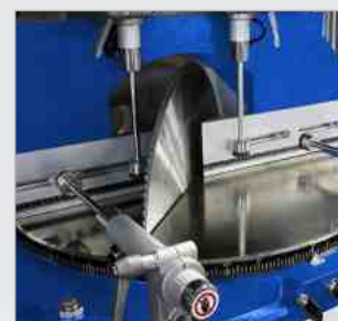
Stufenlose Verstellung des Gehrungswinkels
