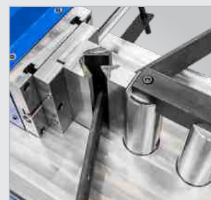
Mit Schnellwechselaufnahme und Seitenanschlag mit Skala
