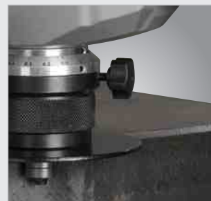
Zur Herstellung von sauberen Sichtkanten z.B. bei Stahlträgern
