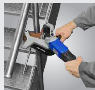
Besonders geeignet zum Bearbeiten von bereits montierten Geländern
