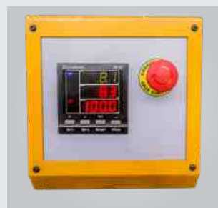
Bedienpult mit Digitalanzeige und NOT-AUS-Schalter
