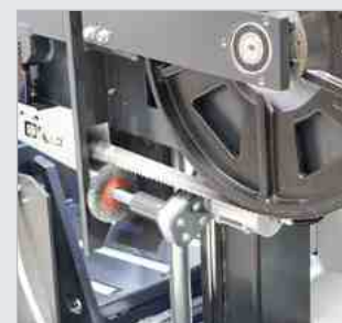
Elektrisch angetriebene Späneräumbürste
