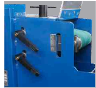
Einfache, werkzeuglose Höhenverstellung des Schleifbandes
