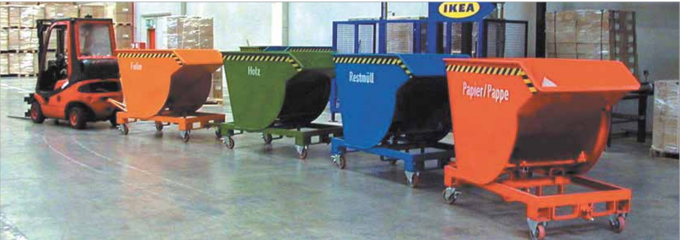
BKM mit Rollen und Anhängervorrichtung mit Deichsel
