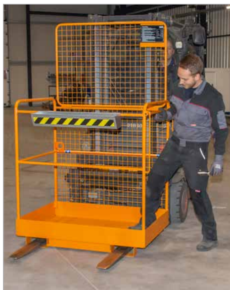
Einstieg durch Heben der Sicherungsstange
