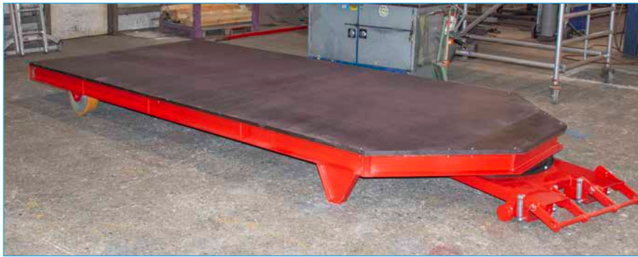
STS mit rutschhemmenden Betosiebplatten
