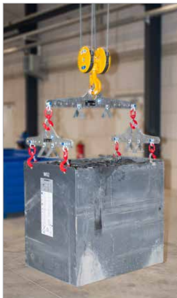
Kombination aus mehreren Traversen zur H-Traverse
