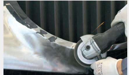
Entlackung mit gleichzeitigem Oberflächen-Finis .
