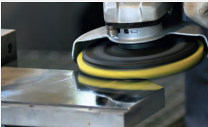
Anschließende Spiegelglanz-Politur mit BRIGHTEX® Poliersystem (Berry + Sun).
