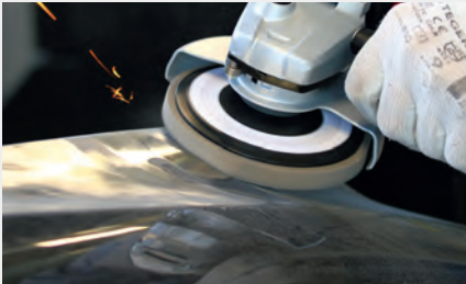
Entfernt gleichzeitig Kratzer, kleine Schweißpunkte und -nähte.
