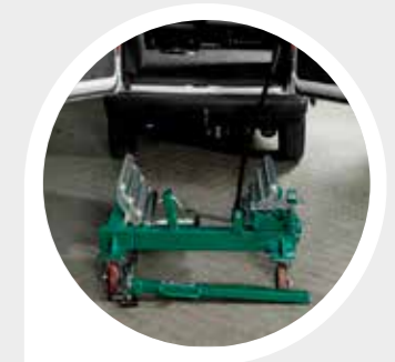
Einfache Handtierung großer Räder mit einem Durchmesser von 1250 mm bis zu 2400 mm und breiten Rädern bis zu 1050 mm.
