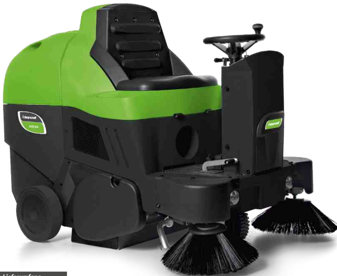
• Mittel- und Seitenbürsten werkzeuglos austauschbar
