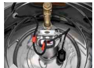
• Edelstahlpumpe für Öle zum Entleeren und Recycling
