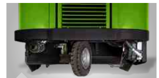
• Der Antrieb über das hintere Antriebsrad ermöglicht wendiges und sicheres Fahren mit sehr engen Kurvenradien
