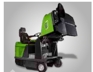
• Hydraulische Entleerung des Kehrgutbehälters bis auf eine Höhe von 1,5 m
