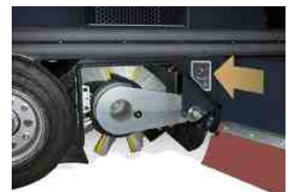
• Hauptkehrwalze werkzeuglos austauschbar. Druck und Höheneinstellung der Hauptkehrwalze sind voneinander unabhängig einstellbar
