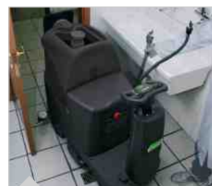
• Frischwassertank mit Schlauch für Schnellbefüllung
