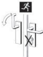
11. Bei Fluchttürschlössern dürfen keine Schließzylinder mit Knauf oder Drehknopf eingebaut werden.
