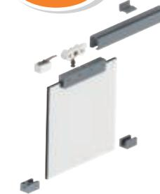
**Schiebesystem 140 ME-A**bestehend aus: **Komplettgarnitur und Laufschiene** · für einflügelige Holzschiebetüren mit minimaler Einbauhöhe **bis****140 kg Flügelgewicht** und Türstärken ab 35 mm · Rollapparate mit Kugellager und Aufhängung
