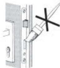
6. Der Drücker darf nur im normalen Drehsinn belastet werden. In Betätigungsrichtung darf auf den Drücker maximal nur eine Kraft von 150 N aufgebracht werden.
