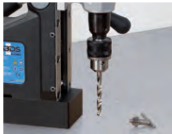
2. Bohrfutter in die Direktaufnahme einsetzen. 3. Einsatzbereit für Spiralbohrer.
