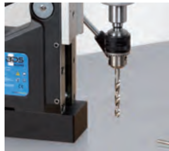
3. Einsatzbereit für Spiralbohrer.
