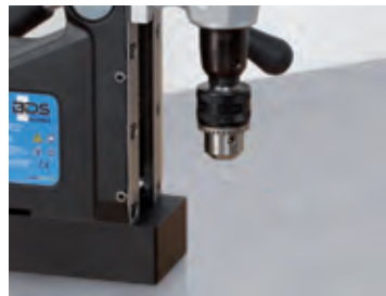
2. Bohrfutter in die Direktaufnahme einsetzen. 3. Einsatzbereit für Spiralbohrer.
