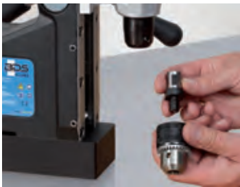
1. Adapter mit Bohrfutter verbinden.
