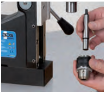
1. Kegeldorn mit Bohrfutter verbinden.
