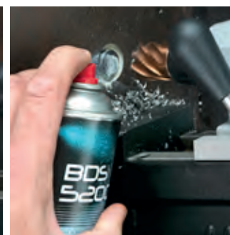
Schritt 2: Während des Bohrens Hochleistungs-fettspray auf die Bohrerspitze und in die Bohrung sprühen.
