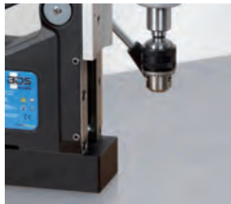
2. Bohrfutter in MK-Aufnahme einsetzen.
