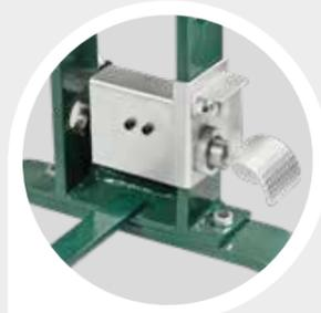
Fußbedienter Schnellhub des Kolbens mit Druckluft. (FP 20/FP 25/FP 30)
