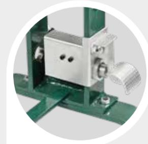
Fußbedienter Schnellhub des Kolbens mit Druckluft.
