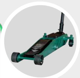
Durch die extrem flache Bauhöhe sind Hebepunkte unter "jedem" niedrigen Fahrzeug erreichbar.
