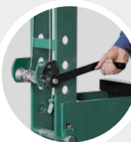
Schnelle und sichere Tischhöhenverstellung über einen einzeln gebremsten Kurbel.
