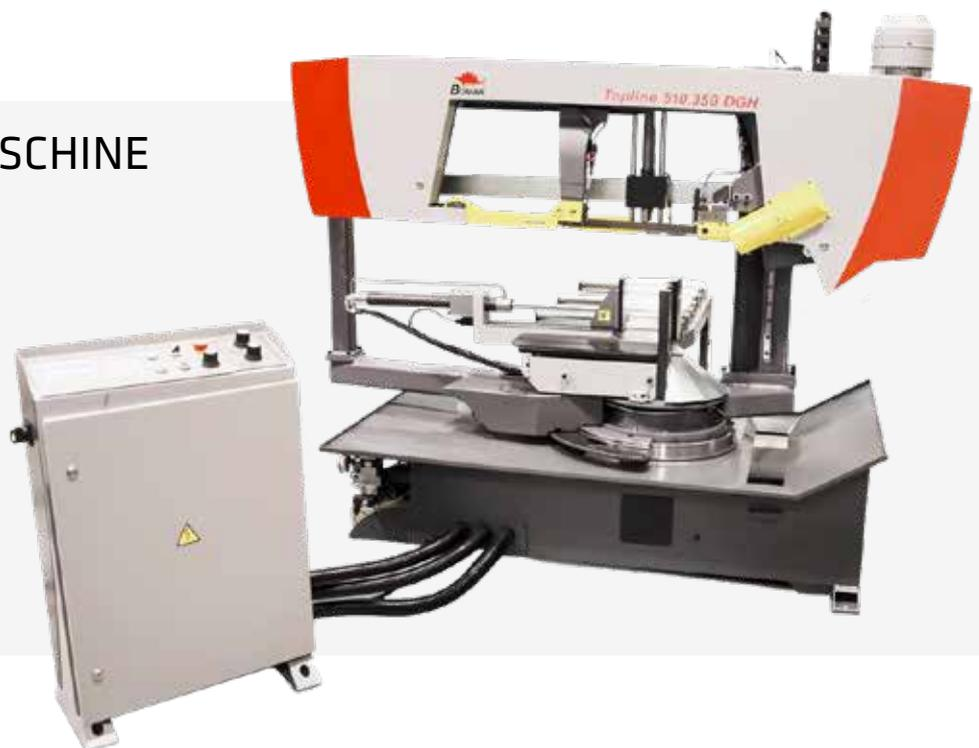
Die halbautomatische Doppelgehrungsbandsäge verfügt über modernste Technik wie Servo-Sägevorschub, spielfreien Direktantrieb und stufenlose Doppelgehrung.
