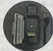
USB Ausgang 5 V / 1 A: Als Powerbank zum Aufladen von Mobiltelefonen etc. nutzbar.
